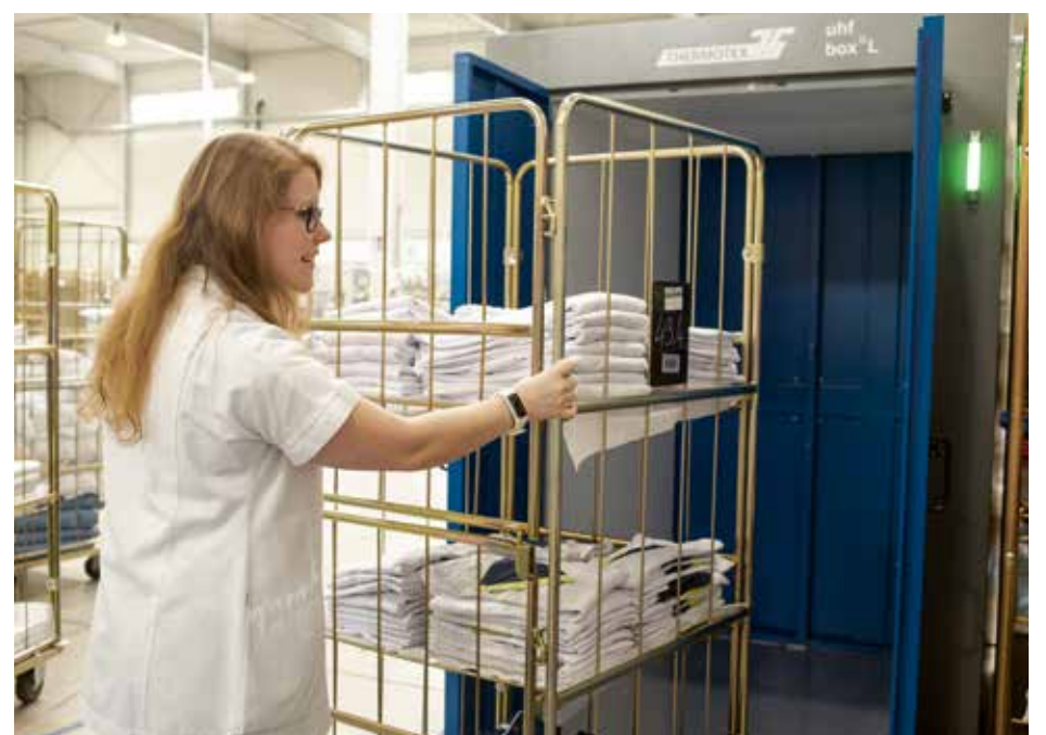
Vor dem Versand werden die Textilien mit Transpondern im Tunnel abgescannt und damit der Bestand aktualisiert.
